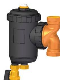
Filtro defangatore magnetico multifunzione serie **MULTIMAG** con valvole a sfera. Adatto sia per sistemi a pompa di calore che per centrale termica grazie alle elevate portate. Triplice azione protettiva grazie ad una doppia rete filtrante interna e al potente magnete da 12.000 gauss. Porta magnete esterno per la facile estrazione durante le operazioni di pulizia. Raccordo connessioni girevole a 360°. Comprensivo di sfiato manuale, valvola di scarico e chiave di apertura.
