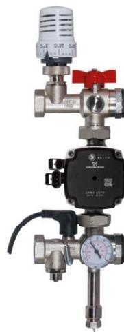
Gruppo di miscelazione a punto fisso serie **THERMOMIX** con valvola miscelatrice termostatica per la regolazione della temperatura di mandata dei collettori, sfiato manuale e termometro a cristalli liquidi, interasse connessioni 200-211mm connessione pompa 1 1/2", campo regolazione valvola miscelatrice: 20-55°C
