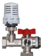
Gruppo di miscelazione a punto fisso serie **VALMIX** con pompa ad alta efficienza, con testa termostatica per la regolazione della temperatura di mandata dei collettori, porta bulbo, termostato di sicurezza, valvola di non ritorno incorporata, valvola a sfera e termometro, interasse connessioni 200mm connessione pompa 1", campo regolazione testa termostatica: 20-70°C
