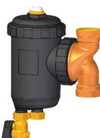
Filtro defangatore magnetico multifunzione serie **MULTIMAG** con attacchi femmina. Adatto sia per sistemi a pompa di calore che per centrale termica grazie alle elevate portate. Triplice azione protettiva grazie ad una doppia rete filtrante interna e al potente magnete da 12.000 gauss. Porta magnete esterno per la facile estrazione durante le operazioni di pulizia. Raccordo connessioni girevole a 360°. Comprensivo di sfiato manuale, valvola di scarico e chiave di apertura.
