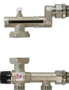
Gruppo di miscelazione a punto fisso serie **THERMOMIX** con pompa ad alta efficienza, con valvola miscelatrice termostatica per la regolazione della temperatura di mandata dei collettori, sfiato manuale e termometro a cristalli liquidi, interasse connessioni 200-211mm connessione pompa 1 1/2", campo regolazione valvola miscelatrice: 20-55°C
