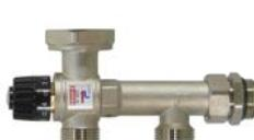
Gruppo di miscelazione a punto fisso con pompa ad alta efficienza, con valvola miscelatrice termostatica per la regolazione della temperatura di mandata dei collettori, sfiato manuale e termometro a cristalli liquidi, interasse connessioni 200-211mm connessione pompa 1 1/2", campo regolazione valvola miscelatrice: 20-55°C
