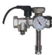
Gruppo di miscelazione a punto fisso con pompa ad alta efficienza, con testa termostatica per la regolazione della temperatura di mandata dei collettori, porta bulbo, termostato di sicurezza, valvola di non ritorno incorporata, valvola a sfera e termometro, interasse connessioni 200mm connessione pompa 1", campo regolazione testa termostatica: 20-70°C
